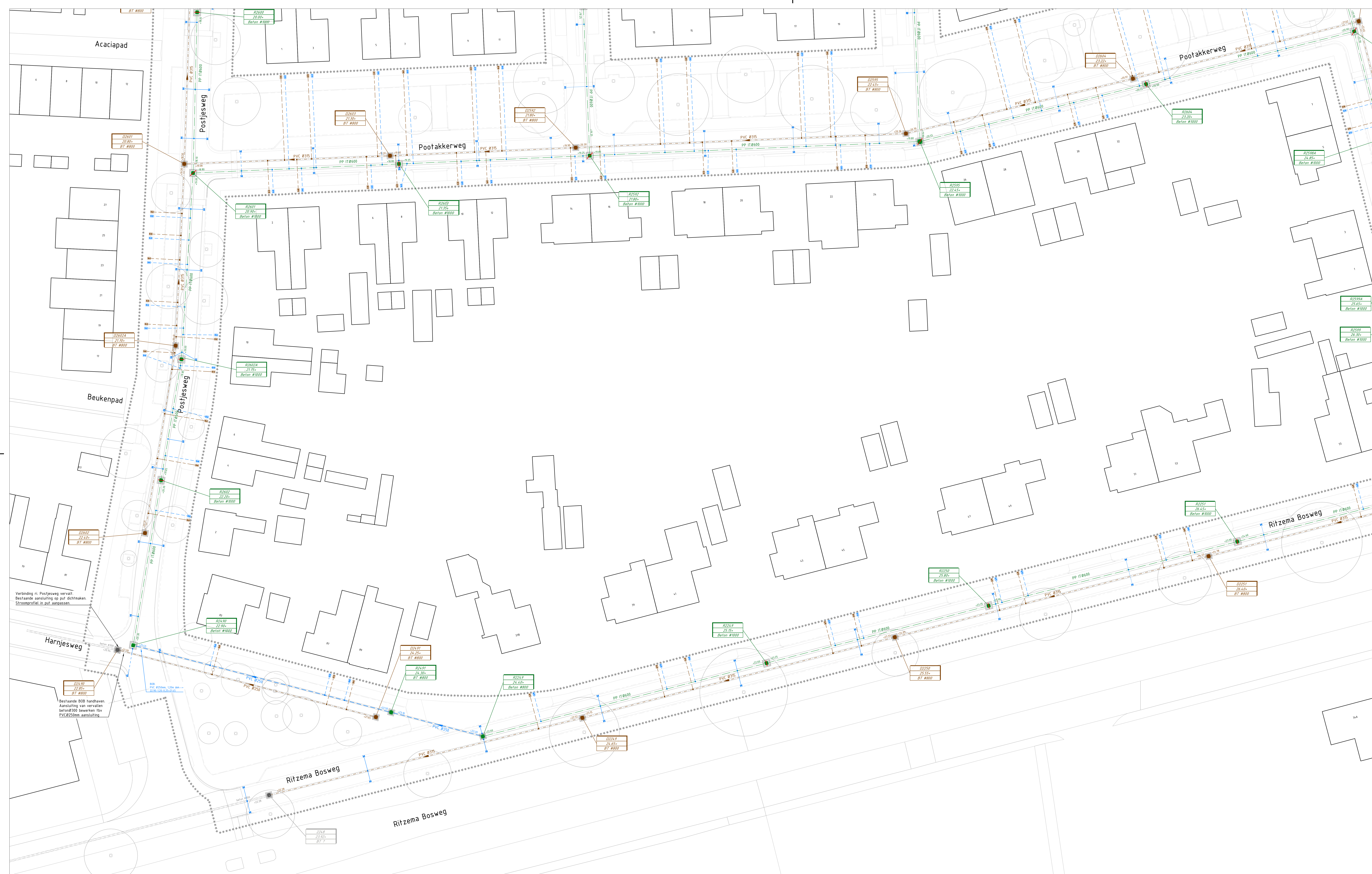
Overzichtstekening riolering nieuwe situatie Schaal: 1:200
